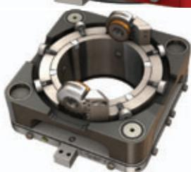
**Вся гидравлика находится внутри корпуса**, что устраняет необходимость использования трубок и фитингов, и, соответственно, уменьшает количество точек возможной утечки. Для привода требуются только два гидравлических подключения.
