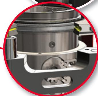
Внутренний вращающийся механизм и наружный неподвижный узел отделяют гидравлическую систему от буровой колонны, **благодаря чему устранена необходимость применения вращающихся гидравлических уплотнений**. Поскольку гидравлические компоненты не контактируют с буровой колонной, приводом можно управлять во время вращения колонны.
