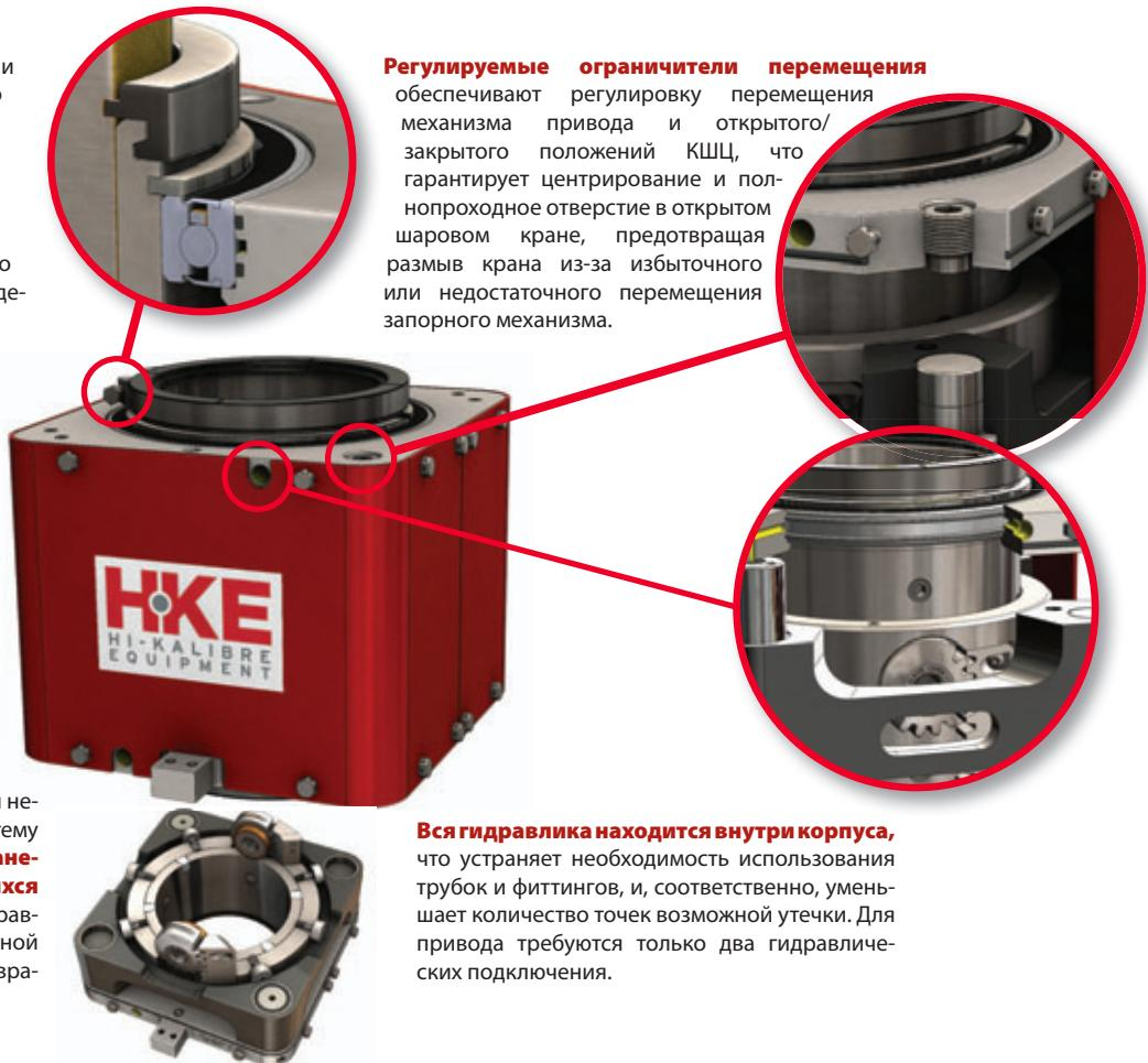
Внутренний вращающийся механизм и наружный неподвижный узел отделяют гидравлическую систему от бурильной колонны, **благодаря чему устранена необходимость применения вращающихся гидравлических уплотнений**. Поскольку гидравлические компоненты не контактируют с бурильной колонной, приводом можно управлять во время вращения колонны.
